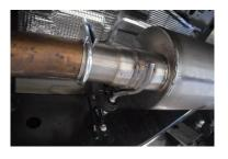
2. SLIDE MUFFLER ONTO THE HEADPIPE 1 1/2" TO 2". SO THAT THE LOCATOR PIN LOCATES INTO THE NTOCH ON THE MUFFLER ASSEMBLY. USE JACK STAND TO SUPPORT THE MUFFLER. ATTACH CLAMP #E AT THE INLET OF THE MUFFLER. THE MUFFLER OUTLET SHOULD BE POSITIONED AT ABOUT 1 O'CLOCK. DO NOT TIGHTEN
