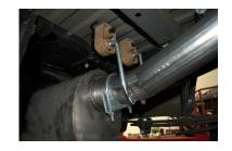
4. INSTALL OVERAXLE TAILPIPE # C INTO THE OUTLET OF THE MUFFLER 1½" TO 2". INSERT WELDED HANGERS INTO THE FACTORY RUBBER GROMMET. USE CLAMP #E TO ATTACH THE OVERAXLE PIPE TO THE MUFFLER OUTLET. DO NOT TIGHTEN.
