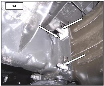
**STEP-3** POSITION THE PASSENGER SIDE FRAME BRACKET OVER THE STUDS AND SECURE THE BRACKET TO THE FRAME USING THE (2) FACTORY NUTS. DO NOT TIGHTEN. **PHOTO #3**
